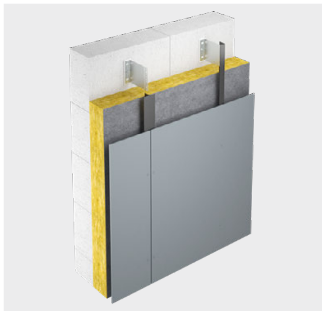
Exempel på väggkonstruktion
