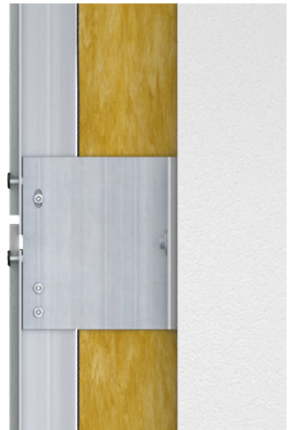
Förskjuten profil skarv i kombination med infästning till vinkelbeslag.
