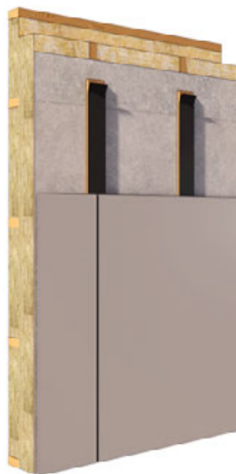
Konstruktion med vertikal träkonstruktion bakom vindskyddsskivan.
