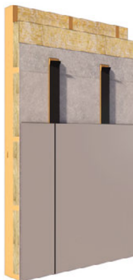
Konstruktion med horisontell kryssregling bakom vindskyddsskivan.
